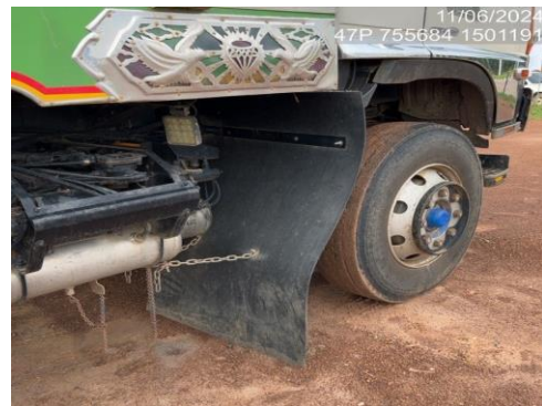
รูปที่ 2-10 การติดตั้งแผ่นกันฝุ่นที่ล้อของรถบรรทุก
